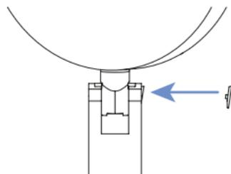
DE Das Kopf Gelenk kann über eine kleine Schraube nachjustiert werden. Nimm dafür vorsichtig die Abdeckkappe am Gelenk ab und ziehe die Schraube mit dem Inbusschlüssel leicht an. Stecke anschließend die Abdeckkappe wieder auf das Gelenk.
