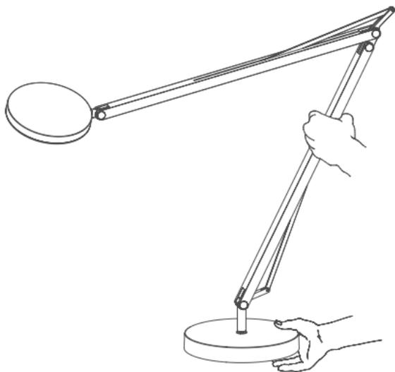
DE Beim Transport der Leuchte bitte Fuß und Leuchte wie gezeigt transportieren, damit der Leuchtenkörper nicht durch einen Überschlag nach hinten beschädigt wird!
