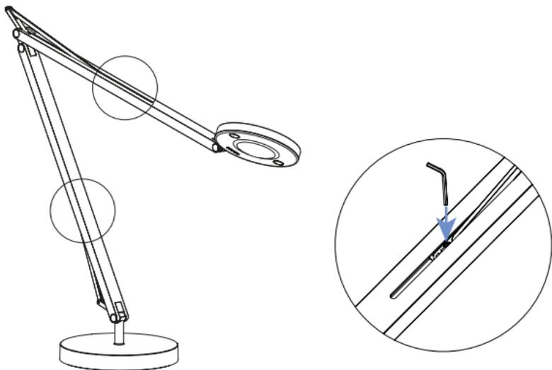
DE Die Verstellkraft des Leuchtenkörpers kann nachträglich angepasst werden. Um die Beweglichkeit zu erschweren, ziehe die Schrauben an den markierten Stellen etwas fester. Um die Beweglichkeit zu erleichtern, lockere die Schrauben ein wenig.
