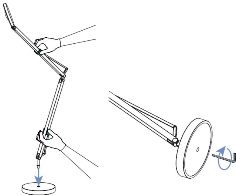
DE Stecke den Leuchtenkörper in den Fuß und ziehe die Sicherungsschraube fest. Zieh die Schraube dabei nicht zu fest an, damit sich der Leuchtenkörper leicht drehen lässt.
